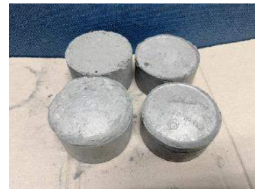
ภาพโลหะดีบุกจากกระบวนการรีไซเคิล
