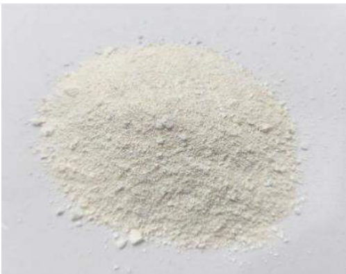
ภาพไทเทเนียมไดออกไซด์จากการรีไซเคิล
