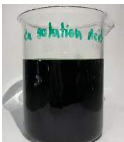
สารละลายทองแดง ที่เกิดจากการกัดวงจรพิมพ์
