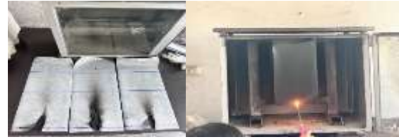
ภาพการทดสอบการลามไฟของต้นแบบหนังเทียม
